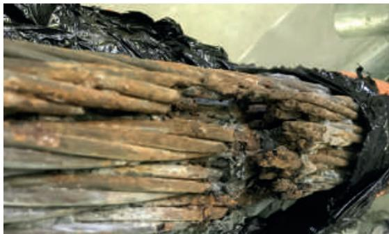
Chaque cas est différent de part sa conception et son exposition. Néanmoins, les facteurs communs sont une ambiance agressive (sels marins ou de déverglaçage) et une mauvaise protection des câbles de précontrainte par défaut d'étanchéité des gaines en polyéthylène haute densité (PEHD) ou de mauvais remplissage des gaines.
