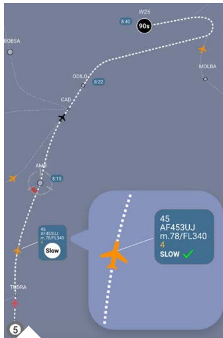
IODA affiche une représentation intuitive de la séquence d'arrivées jusqu'à H-4.
