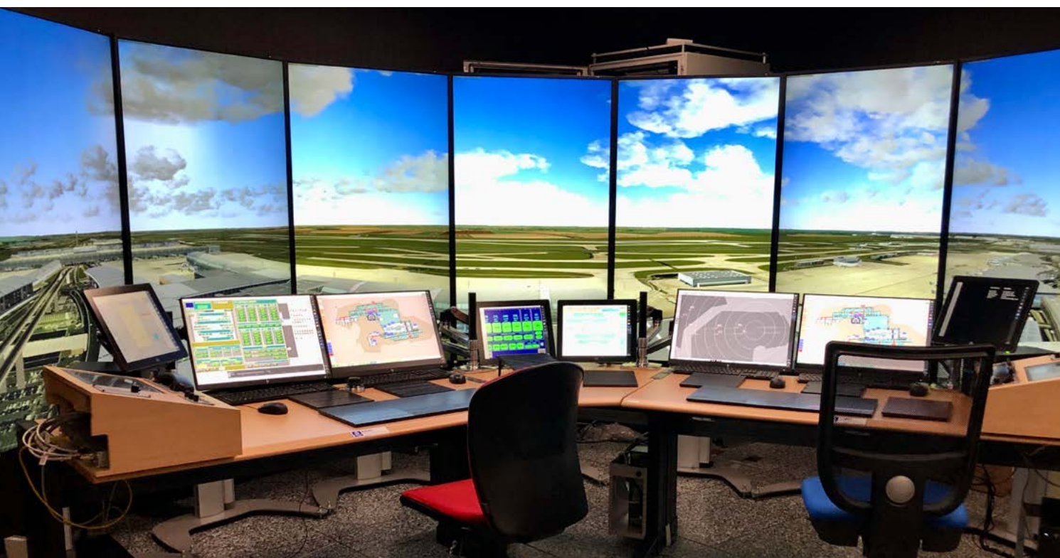
Simulateur LOC à Paris-CDG : pour dispenser une formation au plus près de la réalité opérationnelle, l'organisme de contrôle de Paris-CDG a rénové son simulateur LOC. Ces équipements de nouvelle génération permettent aussi de minimiser les interventions de maintenance.
