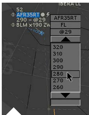
CRNA Est : clairance en niveau (FL) donnée par le contrôleur par Data Link , symbolisée par l'éclair à côté de l'indicatif du vol AFR.
