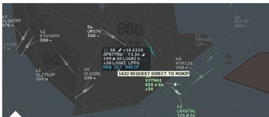
4-FLIGHT : clairance de route donnée via Data Link par un contrôleur du CRNA Sud-Est.
