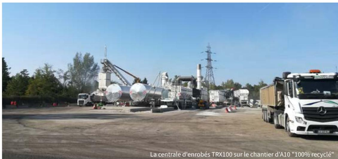
La centrale d'enrobés TRX100 sur le chantier d'A10 "100% recyclé"
