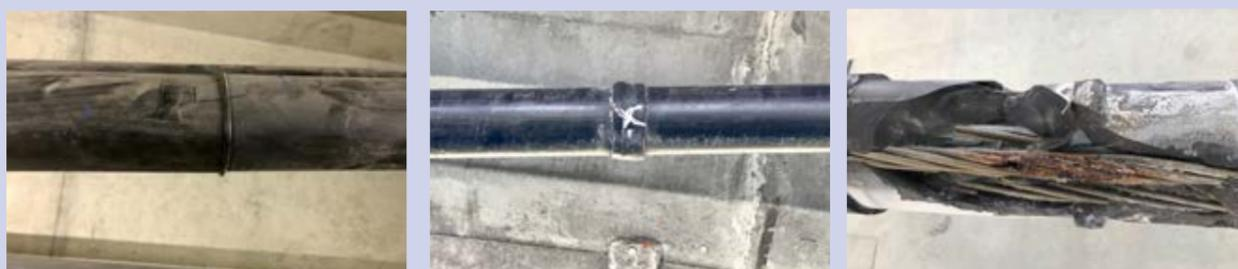
Dans le cas des gaines collectives, le risque de corrosion vient de la gaine qui peut ne plus être étanche :
