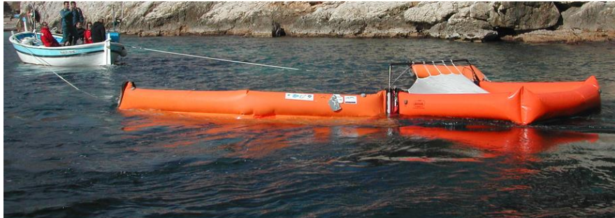
Figure 29 : Mise en œuvre du chalut T2 de CtoSea
