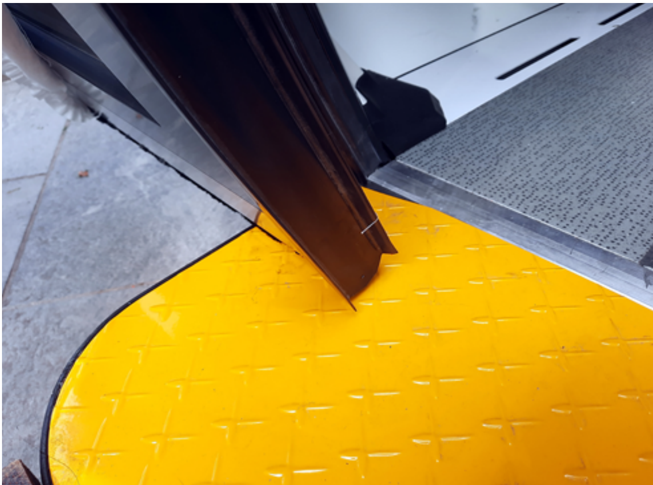
Prototype d'une cabine du Câble 1 avec marchepied plus large que la porte et de couleur contrastée ©SG/DMA.
