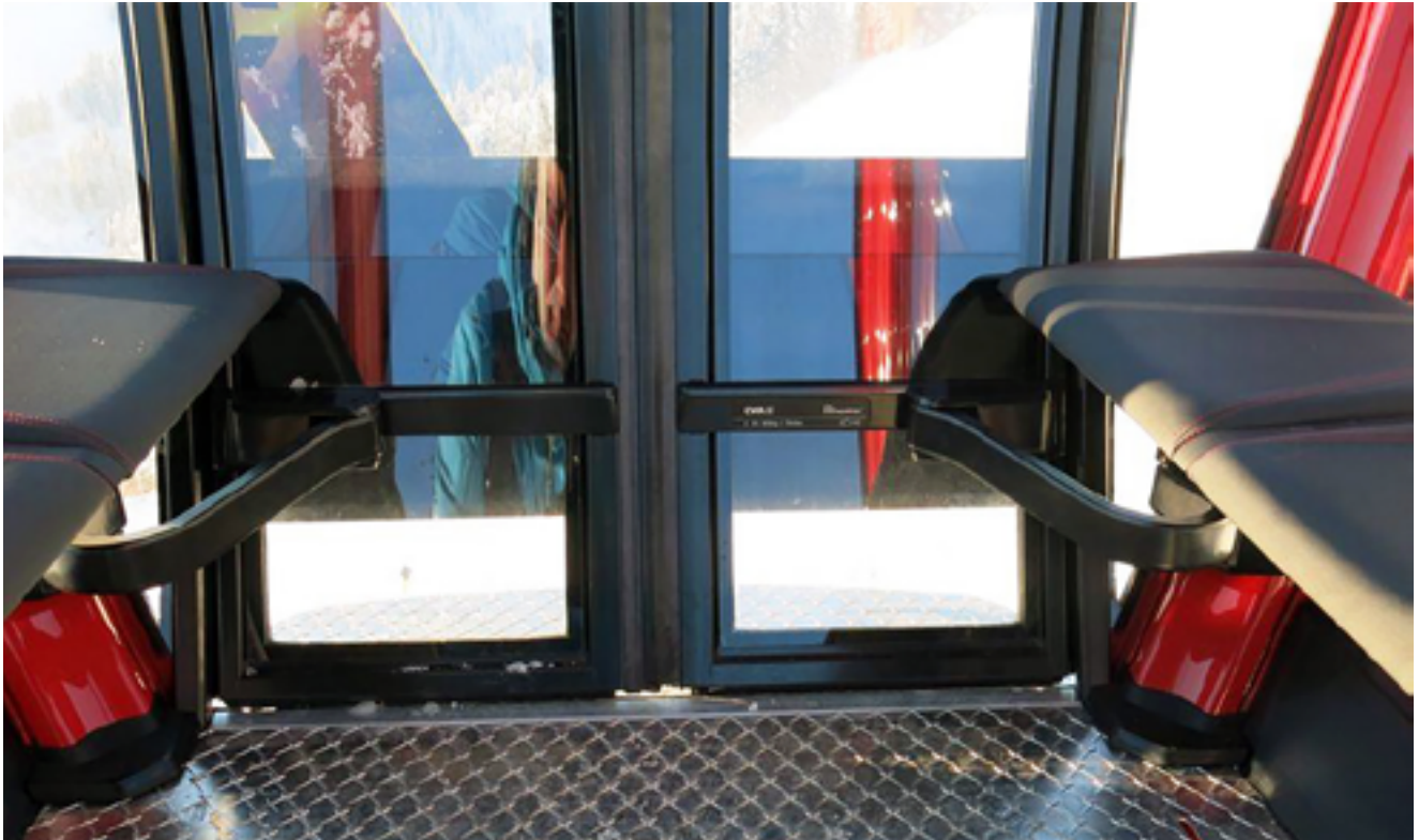
Cabine disposant de portes louvoyantes avec leurs mécanismes d'articulation qui empiètent sous les sièges ©POMA.
