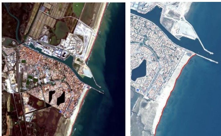
Détection du trait de côte à Port-la-Nouvelle (ligne rouge) à partir d'images satellites : Sentinel-2 , mars 2020 à gauche et Pléiades juin 2020 à droite
