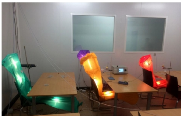
Figure 1. Exposition simulée aux virus en présence de mannequins thermiques (source : Ha et al. , 2016).
